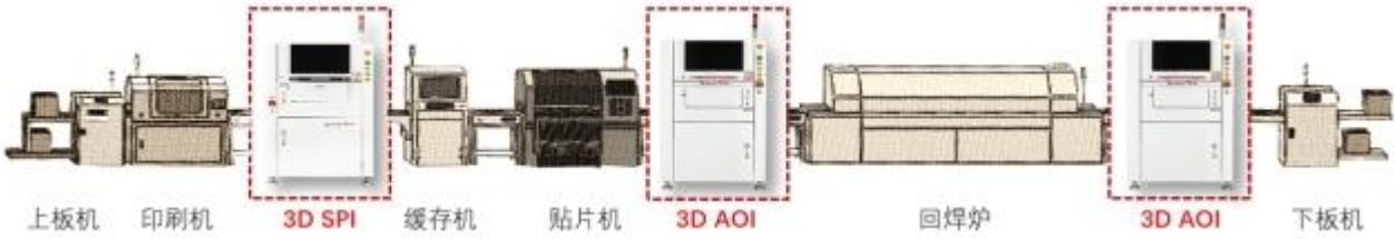
(SMT 生产线示意图，红框内设备为公司主要产品)
